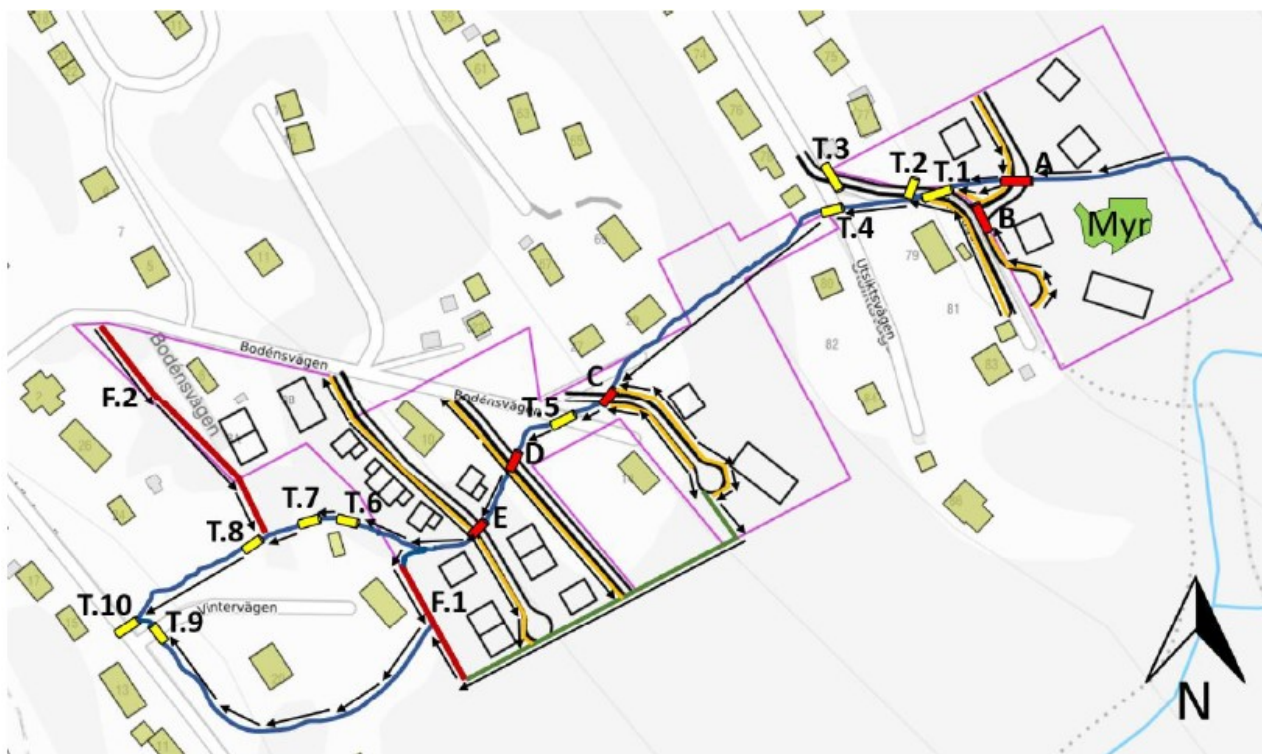
Figur 13. Lösningsslag för dagvattenhantering. Gula cylindrar: befintliga trummor numrerade från 1 till 10; röda cylindrar: trummor som kommer behövas för att säkerställa bäckens rinnväg i och med planerade vägar, numrerade från A till E; Mörkblå: bäcken som är ett biflöde till Kvarnbäcken; Orange: planerade vägdiken; mörkröda streck: rekommenderade fördröjningsdiken F.1 och F.2; grönt streck: avskärande dike som behövs för att få vattnet till fördröjningsdiken; svarta pilar visar rinnvägen; svarta fyrkanter illustrerar planerade huskroppar där ljusgröna fyrkanter illustrerar befintlig bebyggelse. Planområdet är markerat med lila.
