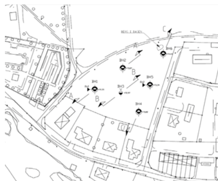
Borrplan från den översiktliga geotekniska undersökningen.
