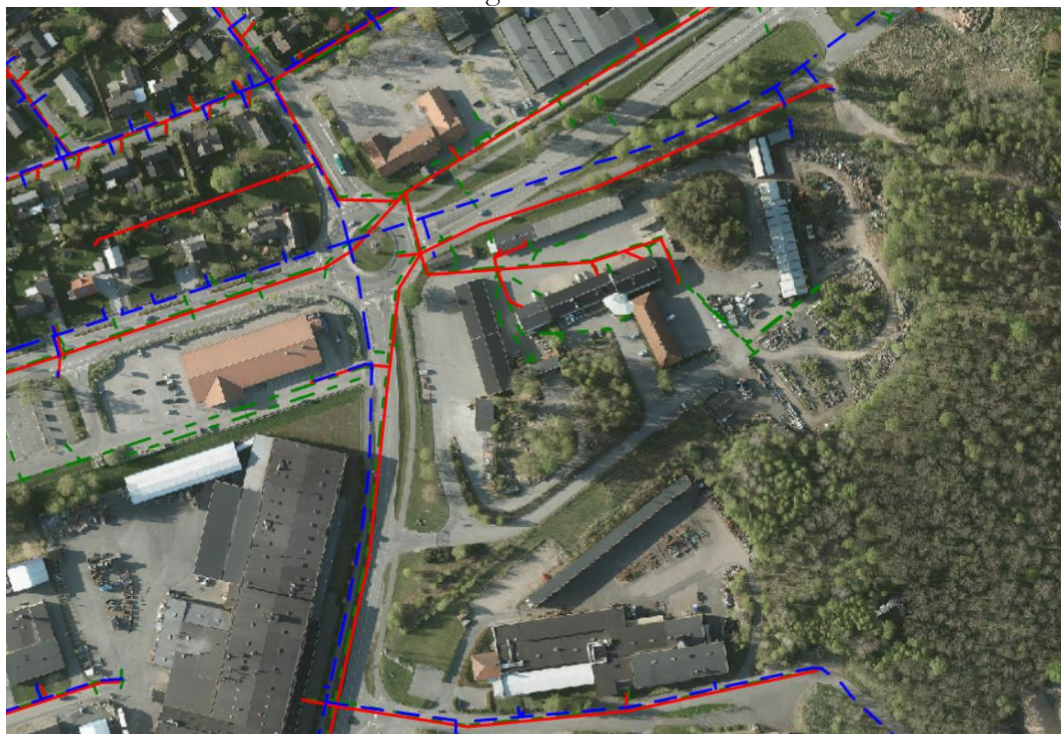
Befintligt VA-nät illustreras ovan. Blå=Vatten, Röd=Spillvatten, Grön=Dagvatten.
