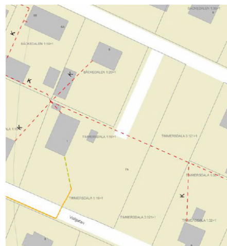
Skövde Stadsnätets kopplingskåp för fiber samt ledningar markerat med grön linje
