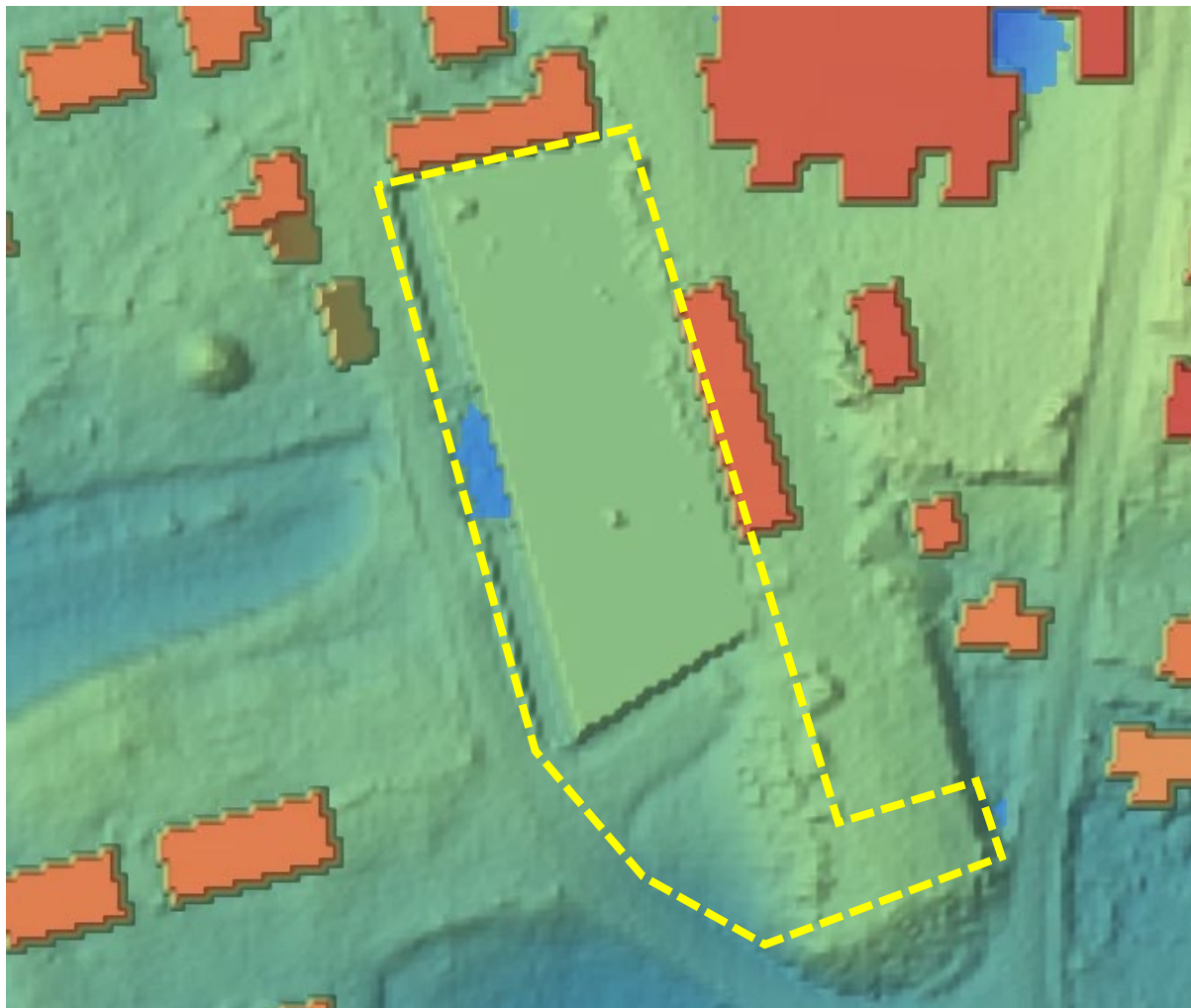
Scalco-genererad bild som visar hur vattenmängder över 25 cm samlas i svackdike då mark inom planområdet har hårdgjort linje (plangränsen har justerats något efter denna bild togs fram).
