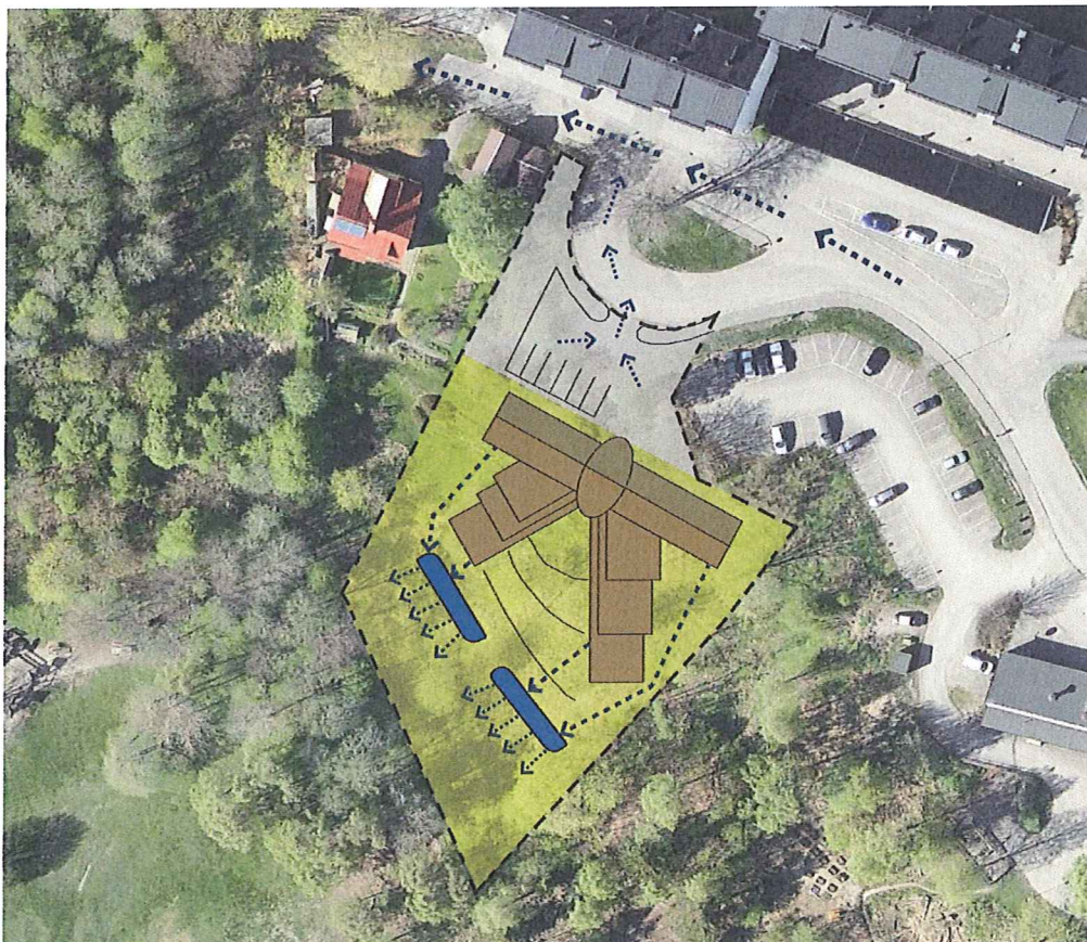
Bild 8. Bilden visar principerna för dagvattenhanteringen i planområdet. Tillkommande dagvatten från ny bebyggelse ska ledas till täta dagvattendammar eller andra fördröjningsmagasin inom planområdet. Från dessa ska vattnet spridas brett över en stor yta. Dagvattendammarna på bilden är dimensionerade för att kunna fördröja ett 100-årsregn, räknat på ett dammdjup på 30 cm. Den mindre mängd dagvatten som kommer från parkeringen kan ledas ut mot Ludvigsbergsvägen genom marklutning, alternativt mot dagvattendammarna om detta är möjligt.
