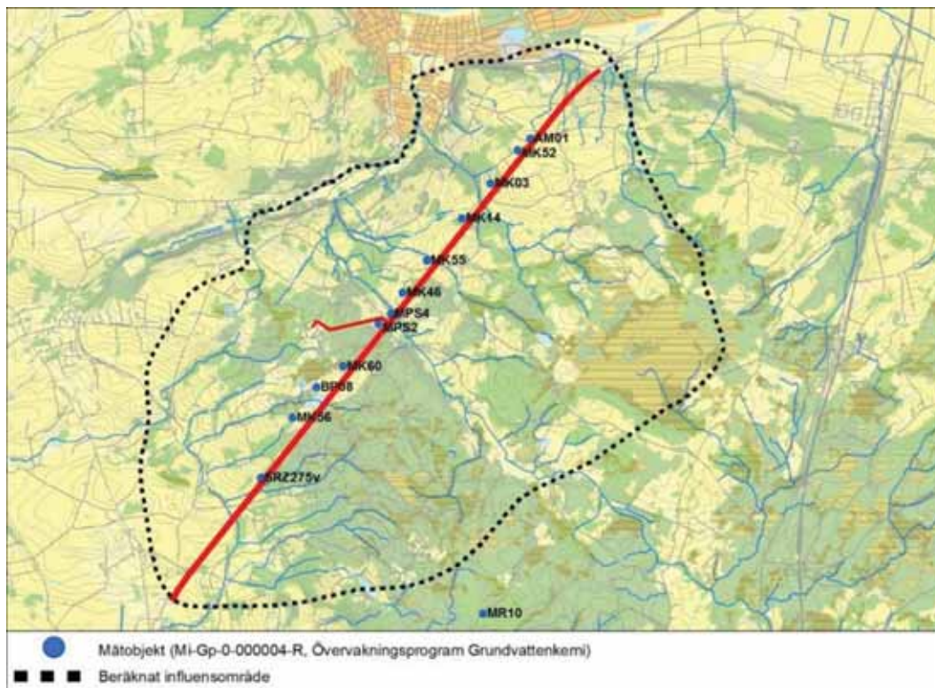
Figur 8. Kontrollpunkter i grundvatten utmed tunnellen.
