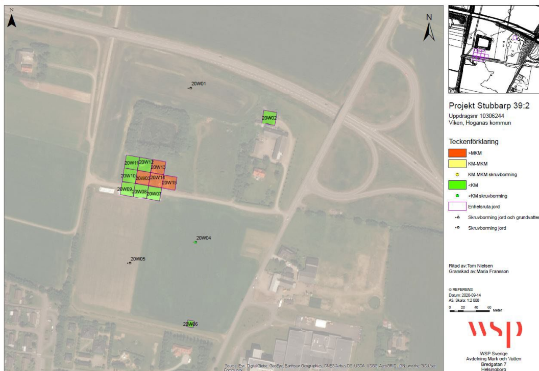
Bild: Bilden visar var proverna har tagits. De röda rutorna visar att det finns föroreningar över riktvärdena för MKM.
