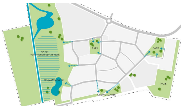
Illustration från gällande plan som visar flödesriktning och översvämningsytor vid extremregn.
