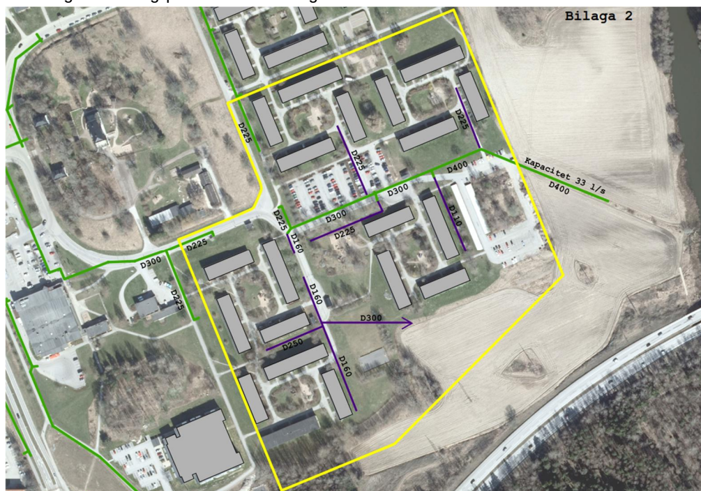
Figur 5. Befintliga dagvattenledningar inom planområdet. Kommunala i mörkgrönt och interna i lila. Dimensioner redovisas i mm. Befintliga dagvattenledningar är tolkade utifrån pappersritningar
