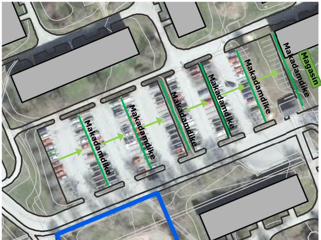
Figur 12. Förslag på dagvattenlösningar för Övrig DP (Befintlig parkering)
