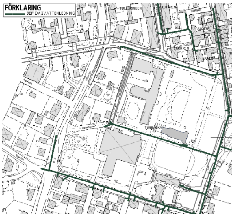
Bild 44: Befintligt dagvattenledningssystem i området (SigmaCivil, 2024)
