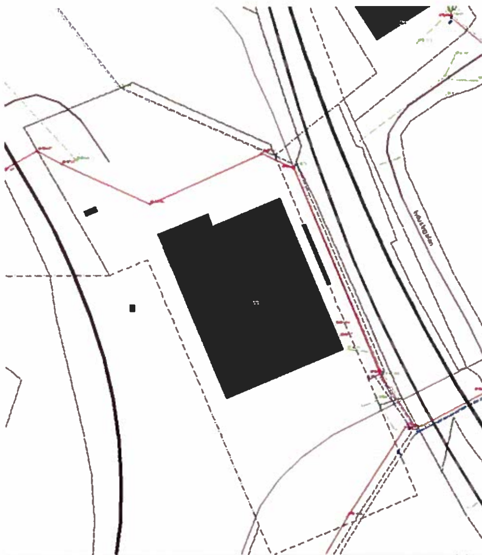
Befintliga dagvattenledningar i planområdet (Grön färg)
