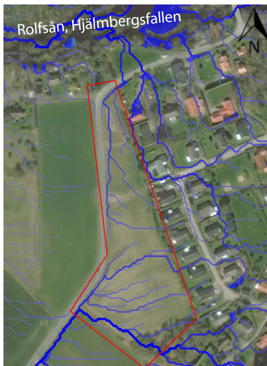
RINNVÄGAR Dagvatten, lågpunkter illustrerade med ett 20 mm regn vid skyfall.
