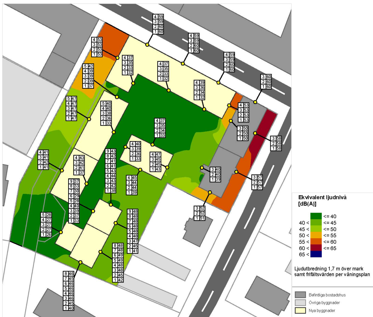
Figur 25. Illustrationen visar ljudutbredning 1,7 meter över mark samt ekvivalent ljudnivå för respektive våningsplan vid fasad. Beräkningen utgår från prognostiserad trafikmängd år 2040.
