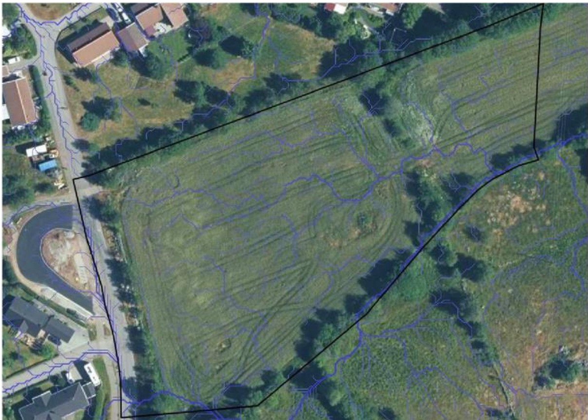
Bild 12. Nuvarande ytliga avrinningsvägar när dagvattenflöden överstiger dagvattennätets kapacitet inom och intill planområdet (SCALGO LIVE 2021). Modelleringen tar ej hänsyn till dagvattenledningar och brunnar. Utkanten av planområdet markeras i svart.
