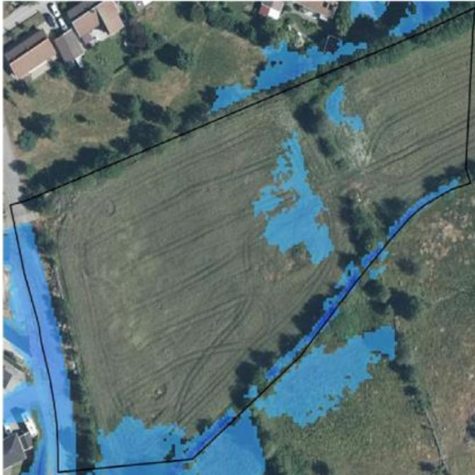
Bild 13. Vid hög nederbörd som avrinner utanför ledningsnätet så ansamlas vatten i de områdena som är blåmarkerade (SCALGO Live 2021). Utkanten av planområdet markeras med svart.
