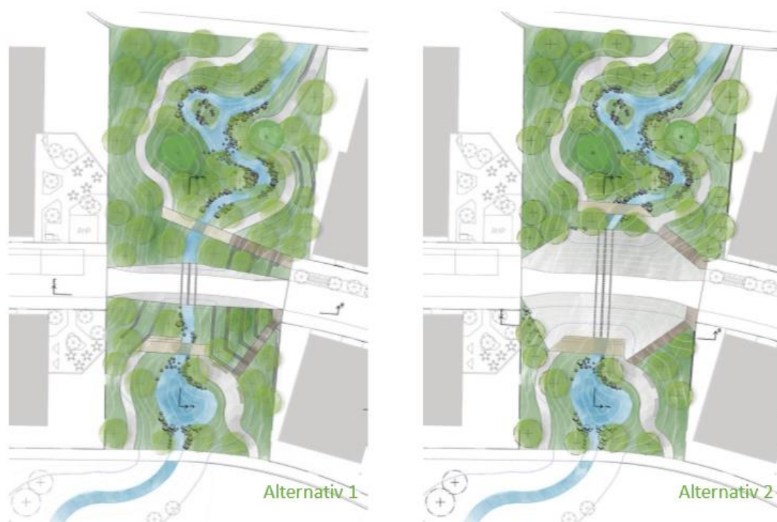
Figur 29. Alternativ 1 visar en möjlig gestaltning som utgår från användandet av gabioner som släntbeklädnad och stödmurar. Alternativ 2 illustrerar en möjlig gestaltning med stenskodda slänter upp mot kvartersgatan. Illustration: Ekologigruppen.
