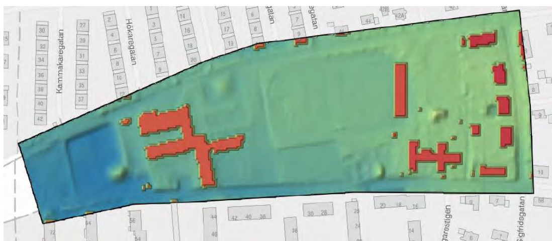
Figur 2. Figuren visar höjderna i området. Varmare färg är högre yta. Figuren visar att vatten generellt rinner från nordöst till sydväst.
