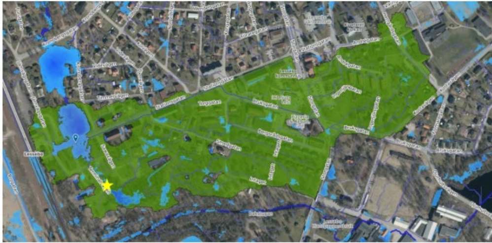
Översvämmad mark och rinnväg vid 64 mm regndjup.
