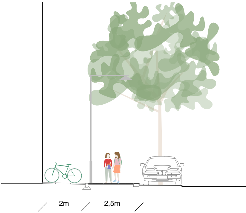
Principsektion. Förgårdsmark med plats för cykelparkering.
