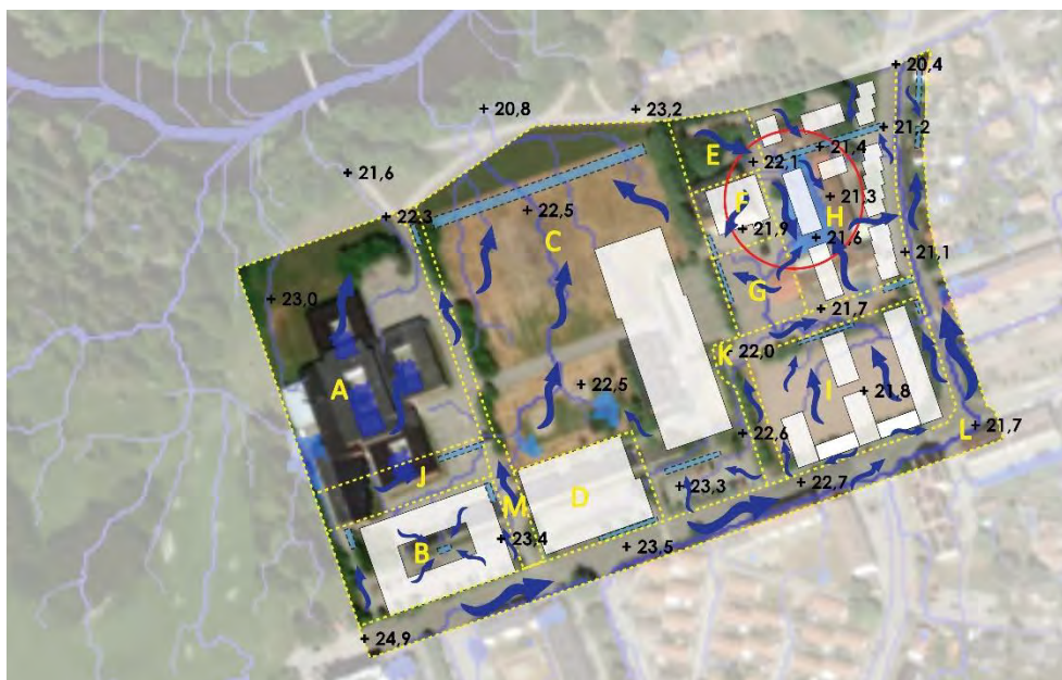
Figur 13: Förväntade flödesvägar inom utredningsområdet med nuvarande höjdsättning. Betydande lågpunkt markerad med röd cirkel.
