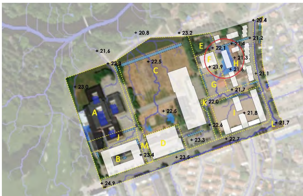
Figur 12: Skyfallskartering och identifierade riskområden efter exploatering, Scalgo. Befintliga höjder markerade i svart.
