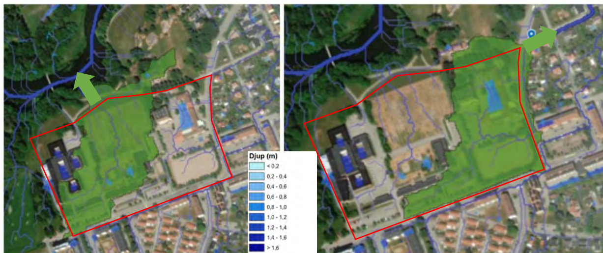
Figur 3: Rinnvägar samt områden med risk för instängt dagvatten. Utredningsområden markerad med rött och avrinningsområdets utloppspunkter markerad med grön pil. Scalgo 2020-12-10.
