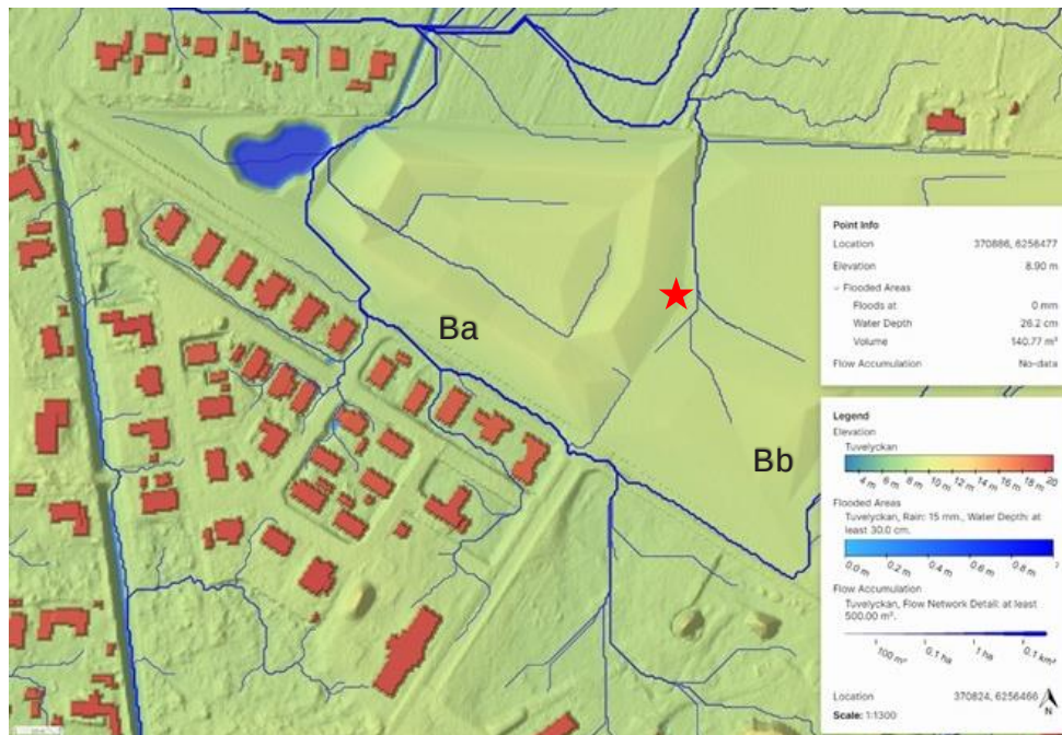
Figur 3: Område B skyfallskartering efter exploatering. 15 mm regn, endast ansamlingar djupare än 30 cm visas (mörkblå). Instängda områden upp till acceptabel nivå i ljusblått. Röd stjärna visar var högsta punkt för stående vatten är (26 cm). (Afy, 2024-01-31)
