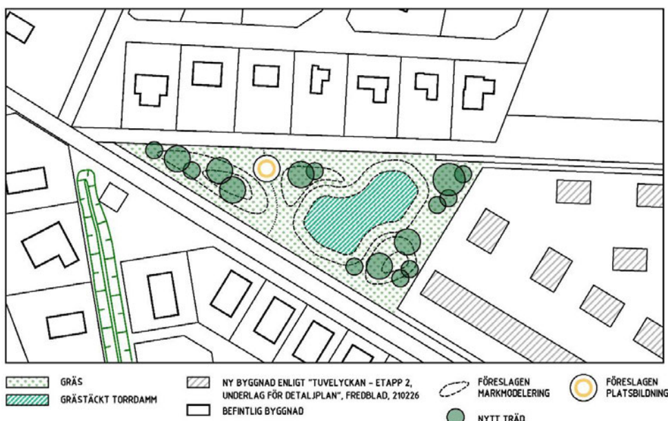
Principskiss - Fördröjningsmagasin (torrdamm) i nordväst (Bild: Afry, 2024-01-31)
