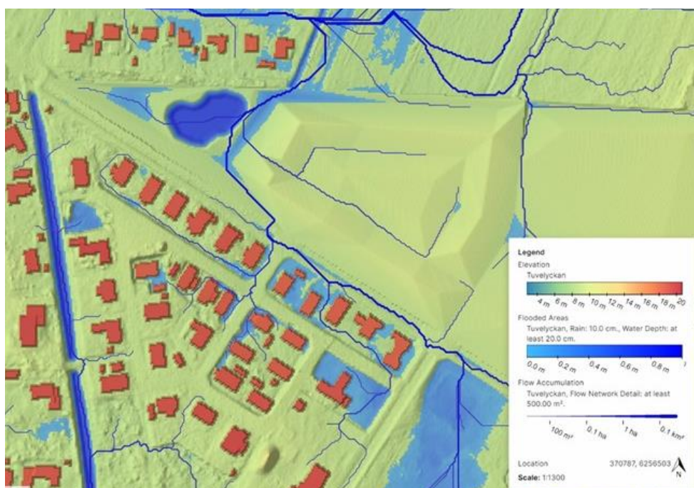
Figur 2: Område B skyfallskartering efter exploatering. 100 mm regn, endast ansamlingar djupare än 20 cm visas (mörkblå). Instängda områden upp till acceptabel nivå i ljusblått. (Afry, 2024-01-31)
