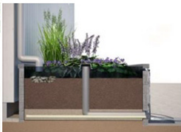
Exempel på upphöjd växtbädd som tar emot dagvatten från tak via stuprör (Afry, 2024-01-31)
