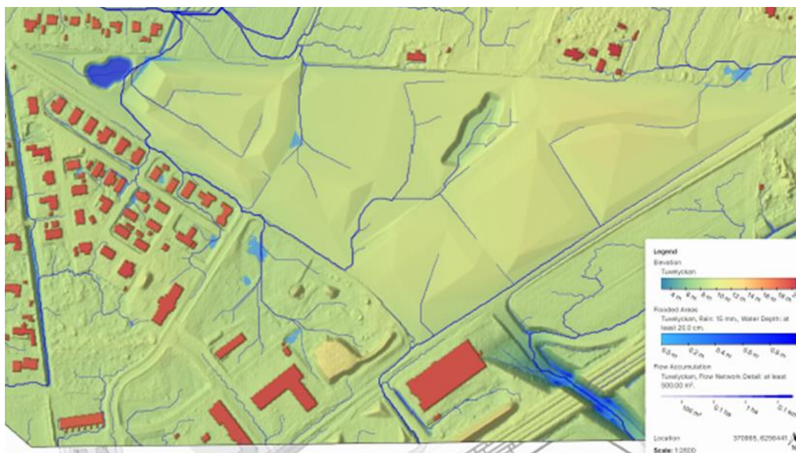
Figur 1: Område B skyfallskartering efter exploatering. 15 mm regn, endast ansamlingar djupare än 20 cm visas. (Afry, 2024-01-31)
