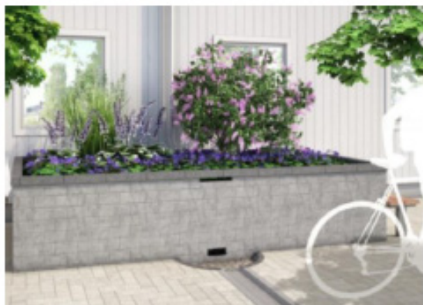
Exempel på upphöjd växtbädd som tar emot dagvatten från tak via stuprör (Afry, 2024-01-31)
