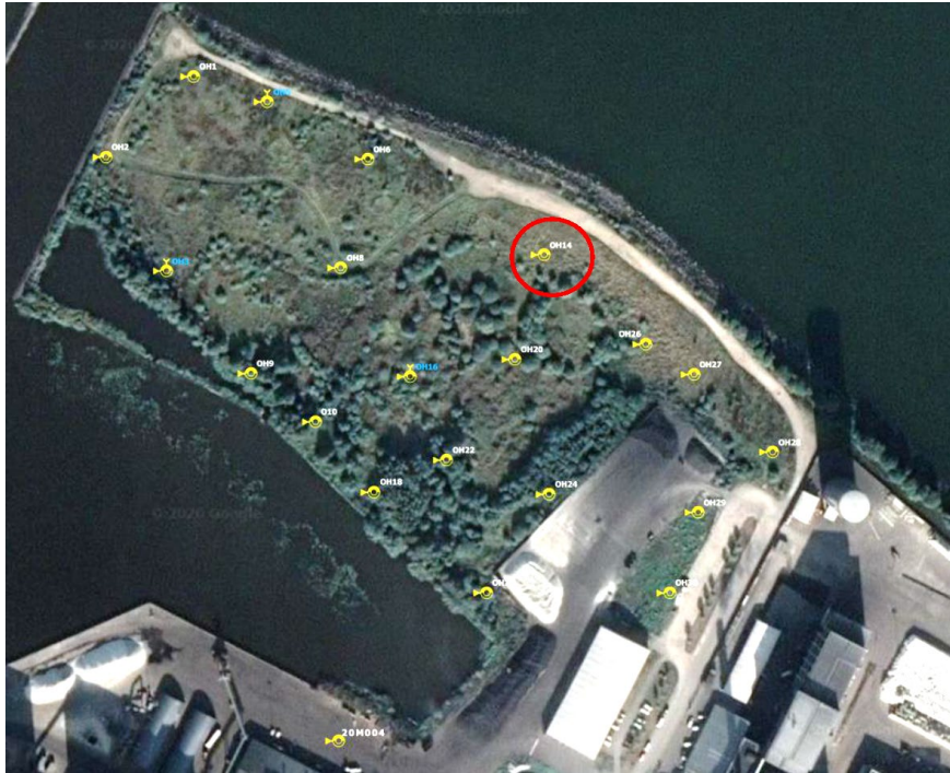
Fig. 21 Provpunkter inom området. Provpunkt där förhöjda halter (över MKN) påträffats av PAH-M och PAH-H på ett djup av 3,0 - 3,5 meter under markytan markeras med röd cirkel.
