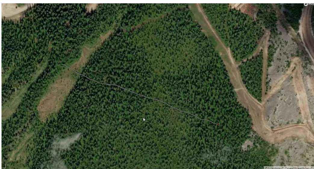
Figur 4. Linjen i grått visar placeringen av mätningarna med 160 MHz-antenn den 2023-03-29. Grön punkt markerar mätlinjens start vid planerad liftpåstigning och röd punkt markerar slutet.
