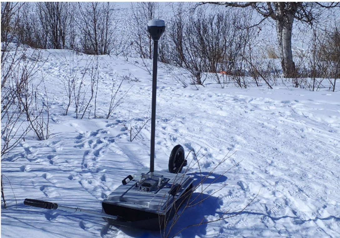
Figur 1. Använd mätutrustning, Malå GX160 HDR, dragen manuellt (foto Tyréns). Bild tagen på annan plats samma dag som undersökningen (foto Tyréns).
