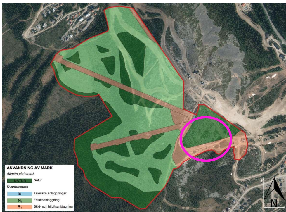
Figur 38. Den rosa cirkeln visar området där risken för blocknedfall kan göra det aktuellt att anlägga passiva skyddsnät. Området som berörs planläggs med markanvändning skydd (mörkgrönt) samt R 1 Skid- och friluftsanläggning (beige) (Härjedalens kommun, 2024).
