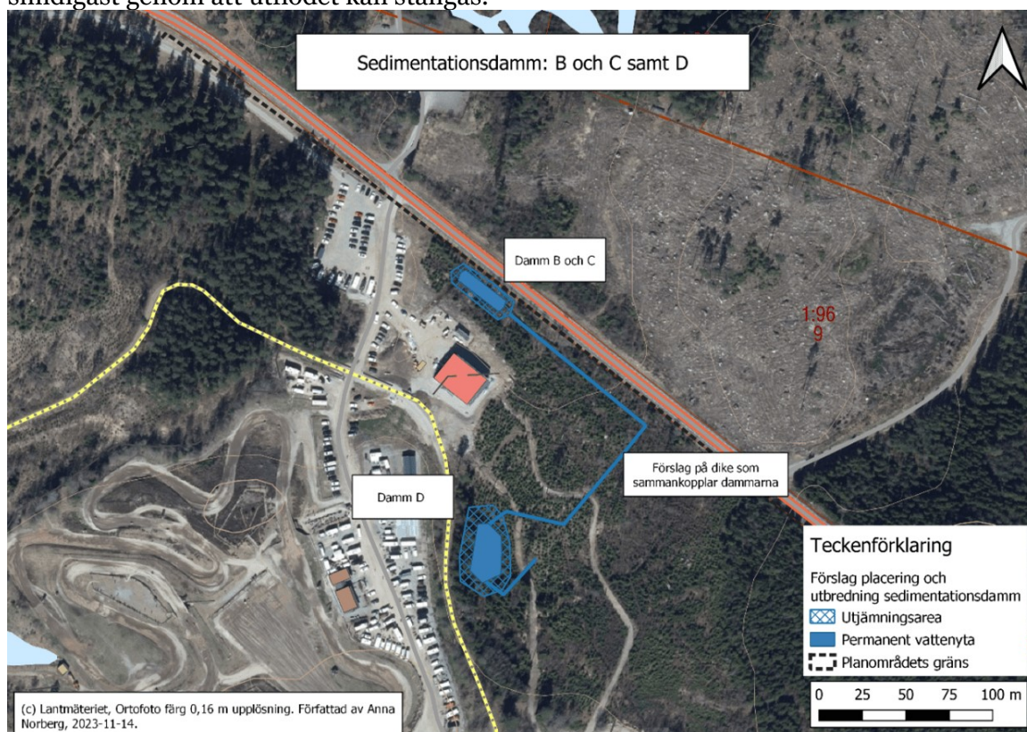
Figur 9: Karta från dagvattenutredning med exempel på placering av sedimenteringsdamm åt verksamhetsmarken utmed Stockarydsvägen. Dammarna utgörs av en permanent vattenyta samt en utjämningsarea som används som fördröjningsmagasin vid skyfall.
