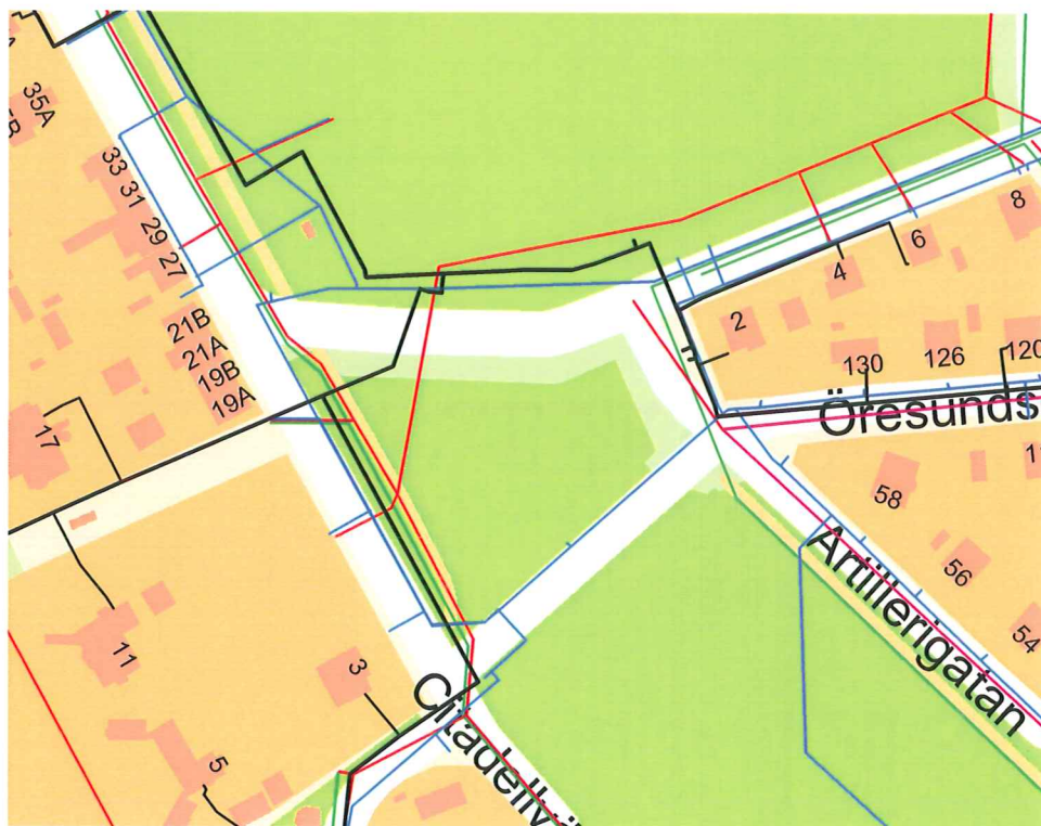
Fig 15. Ledningar inom och i närheten av Lägerplatsen
