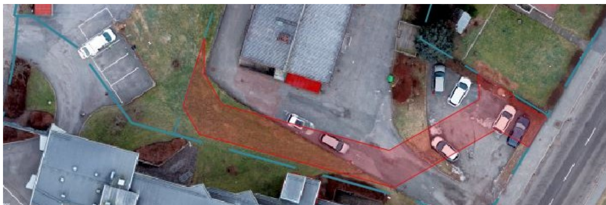
Drönarfoto med reserverad yta för tilltänkt dragning av avloppsledning markerad i rött.
