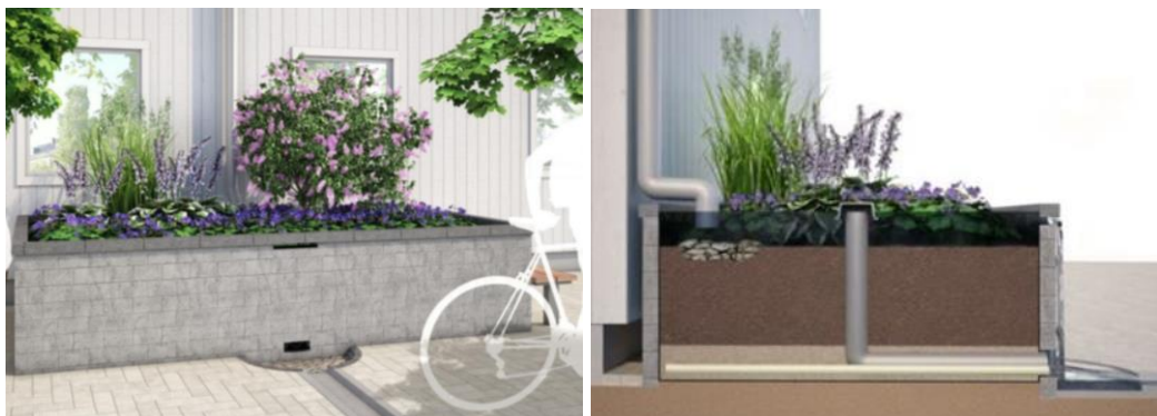
Figur 42. Exempel på upphöjd växtbädd som tar emot dagvatten från tak via stuprör (Foto: Vinnova).
