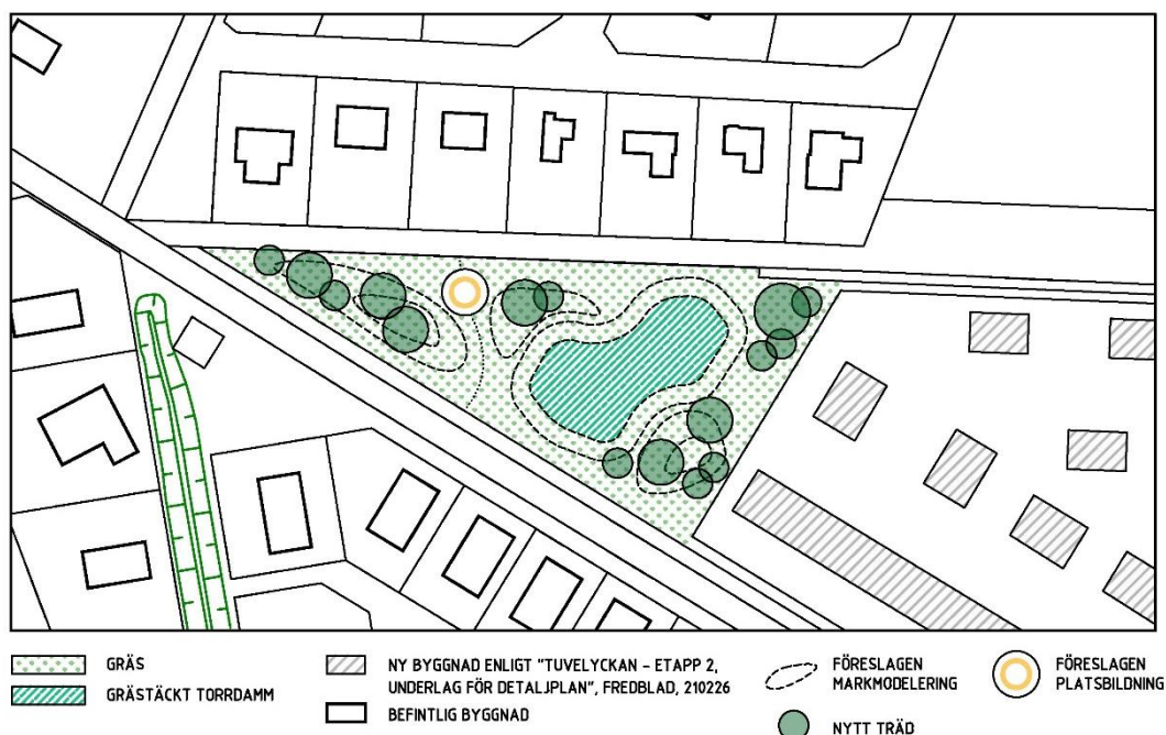
Figur 24. Visar ett förslag på gestaltning av torrdammen i område Ba framtaget av AFRY.
