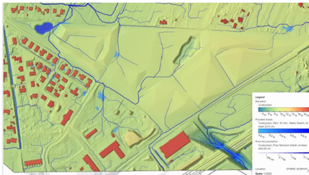
Figur 32 Område B skyfallskartering efter exploatering. 15mm regn, endast ansamlingar djupare än 20 cm visas.
