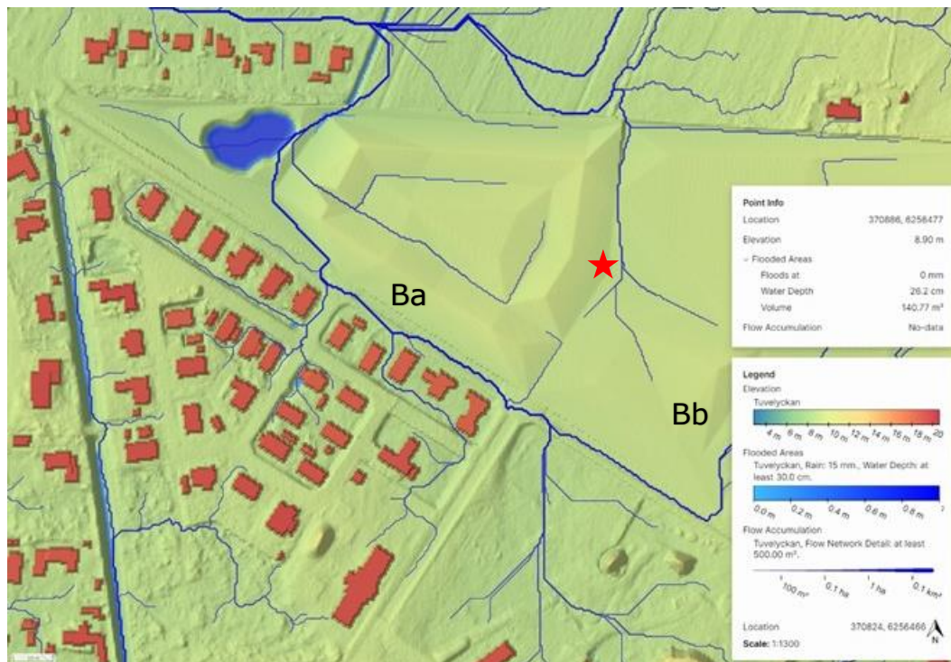
Figur 34 Område B skyfallskartering efter exploatering. 15mm regn, endast ansamlingar djupare än 30cm visas (mörkblå). Instängda områden upp till acceptabel nivå i ljusblått. Röd stjärna visar var högsta punkt för stående vatten är (26 cm).
