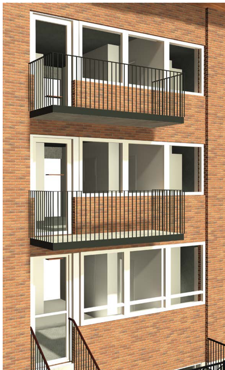
Exempel på utfyllnad i samband med balkongdörr
