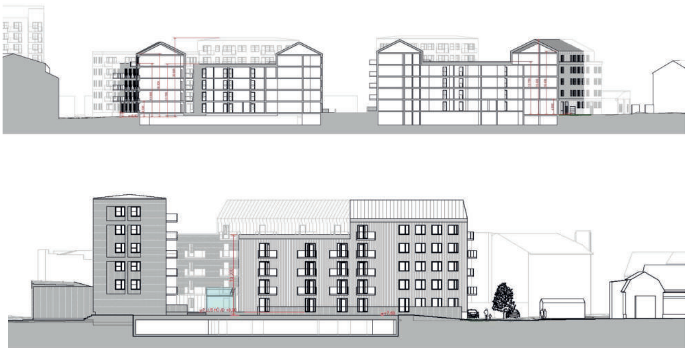
Bild 20: Sektion av föreslagen exploatering. Övre bild visar en sektion i nord-sydlig riktning genom kvarteret. Nedre bild visar en sektion i öst-västlig riktning med föreslagen passage och gatuutformning av Bryngelshusgatan. (För situationsplan och fler skalenliga ritningar se ARKKAS arkitekter 2023-08-30)
