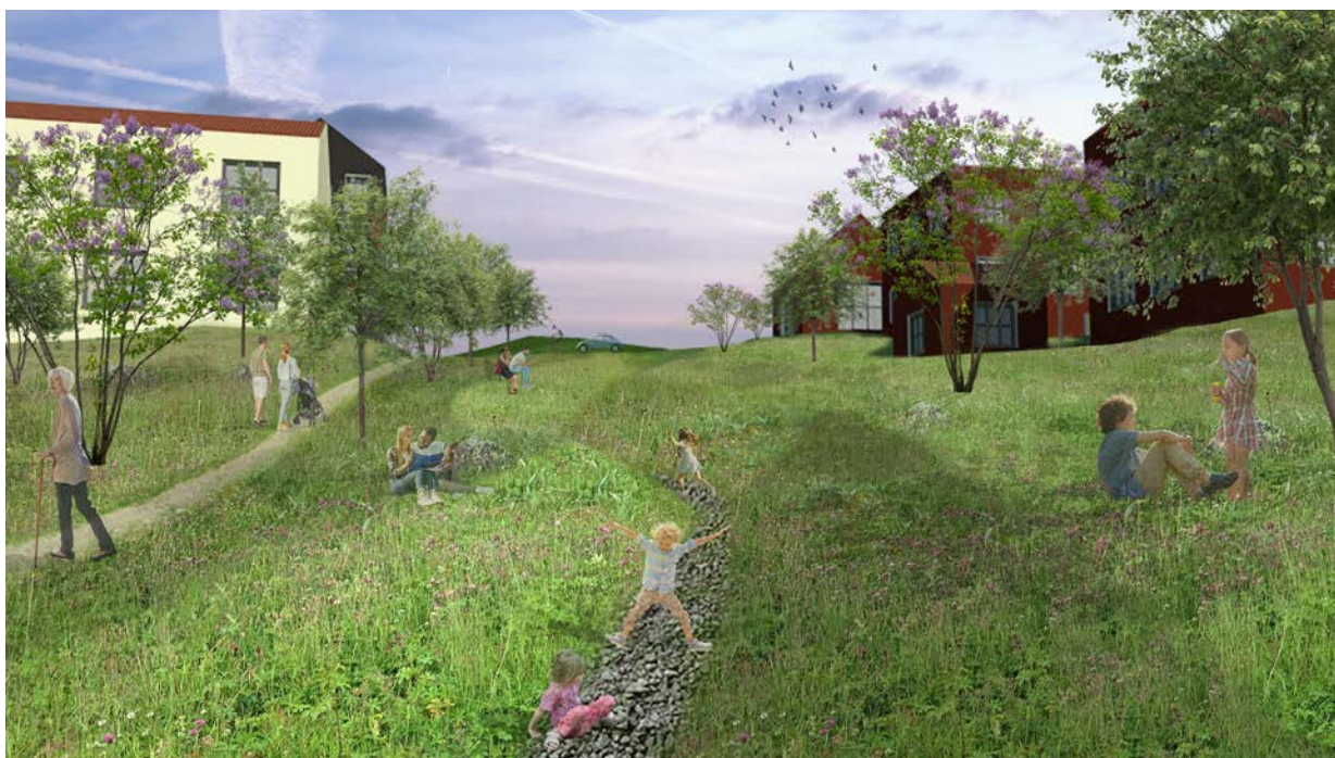
Figur 10. Bilden visar hur ett torrlagt svackdike kan se ut mellan byggnaderna. Svackdiket leder dagvattnet nedströms samtidigt som vattnet både fördröjs och renas från trafikföroreningar innan det förs vidare. Därmed minskar risken för översvämningar samtidigt som vattenkvaliteten och vattenbalansen förbättras (Burns et al. 2012).
