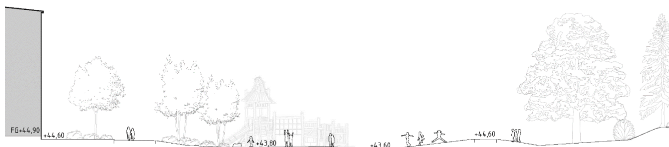
Figur 34. Illustration som visar en sektion av föreslaget lågpunktsområde på skolgården. Sektionen är markerad i illustrationsplanen ovan som B-b (Novaterra).
