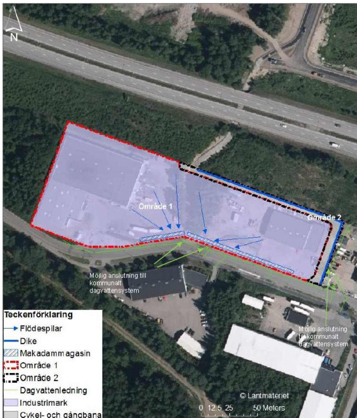
Figur 12. Principskiss med ungefärliga placeringar av föreslagen dagvattenhantering. Blåstreckade ytor symboliserar förslagen på ungefärlig placering av makadammagasin inom planområdet. Gröna pilar visar möjliga anslutningspunkter till det kommunala dagvattensystemet.
