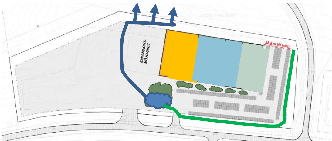
Figur 9. Förslag på placering av utjämningsmagasin i form av damm i blått, svackdiken i grönt och utlopp i blått, som kan vara ledning, svackdike, täckdike eller en kombination av dessa.
