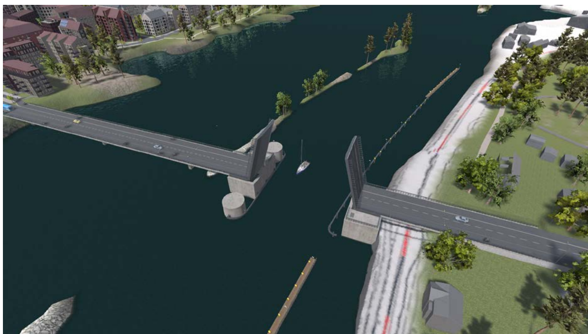
Princip för dubbelklaffbro
