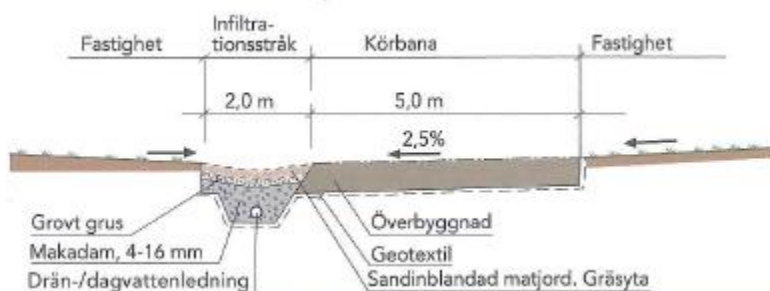
Principskiss på gatusektion med infiltrationsstråk med gräsyta, Svenskt Vatten P105
