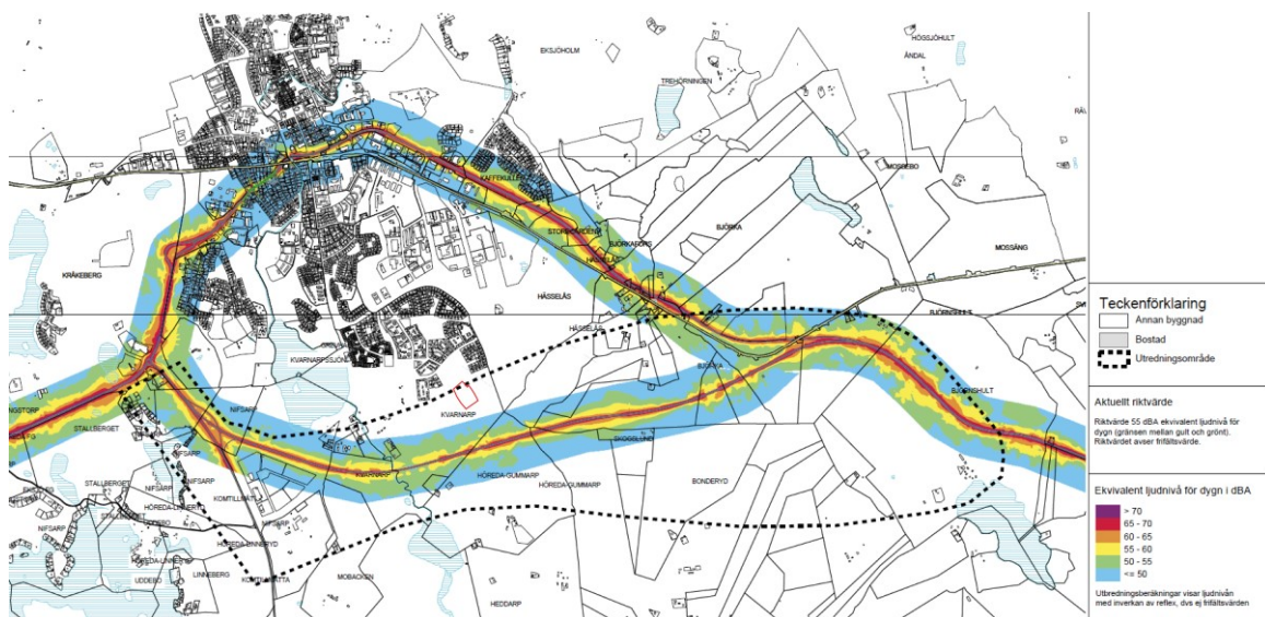
Figur 6: Bild på bullerutredning för beslutat alternativ "korridor röd" två meter över mark. Från PM Bullerutredning Väg 40 förbi Eksjö 2016-11-30. Planområdet är illustrerat med röd linje.
