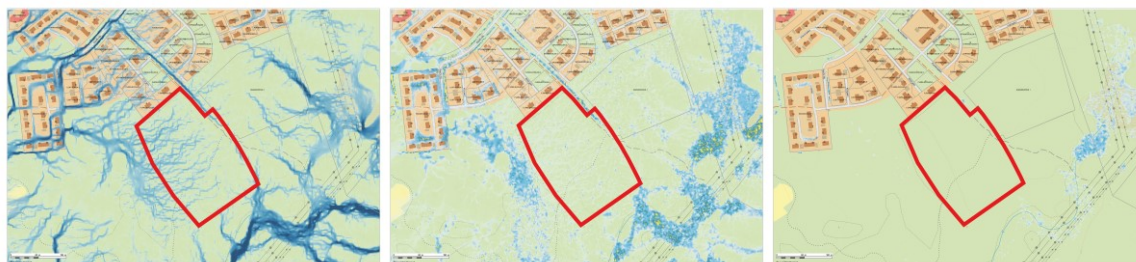
Figur 7: Bilder från kommunens skyfallskartering. Max flöde (vänster), Maxdjup (mitten) och Maxdjup efter 8 timmar (höger). Planområdet är illustrerat med röd linje.
