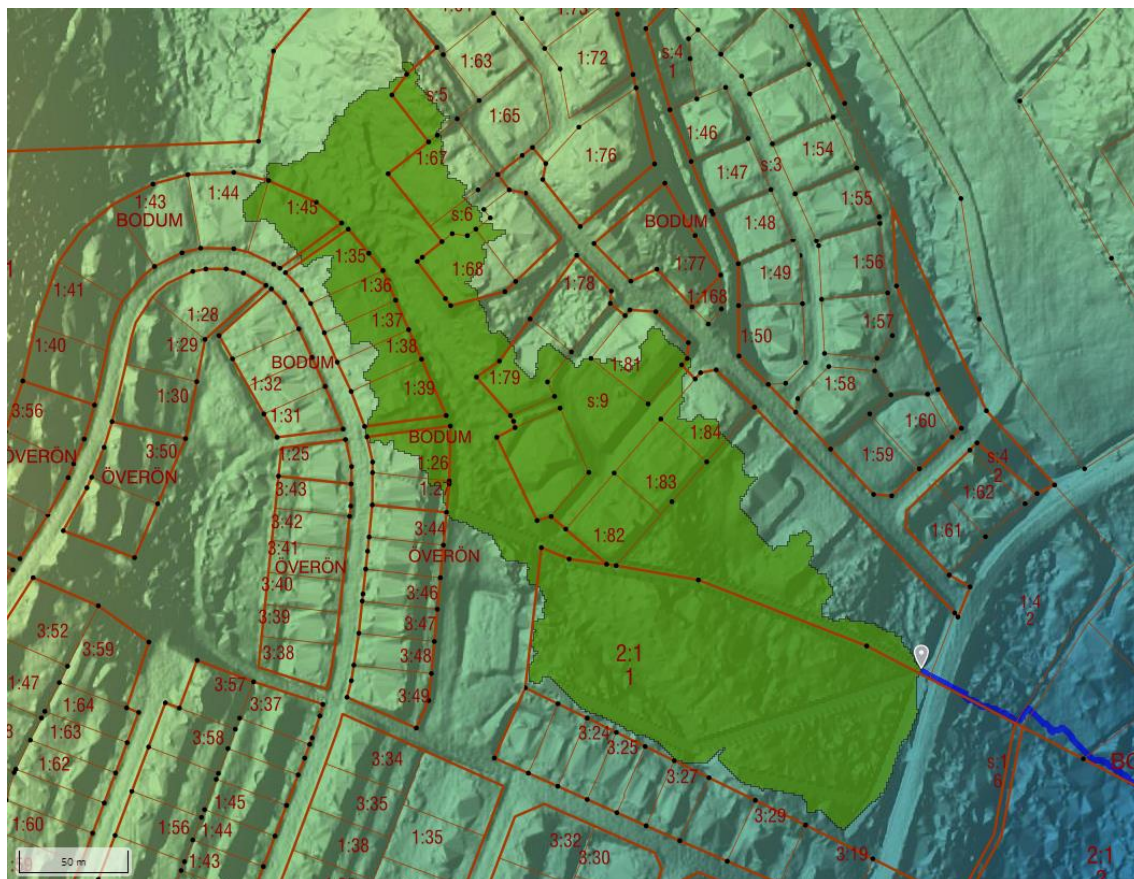
Figur 15: Avrinningsområdet som belastar trumman under Bonäsvägen vid föreslagen dagvattenhantering. Modellering av diken är gjord i Scalgo live (Scalco, 2021).
