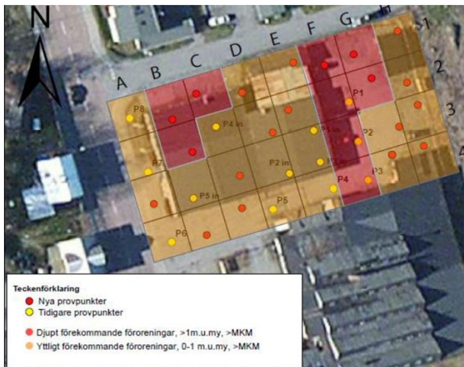
Samtliga provtagningspunkter på fastigheten. Källa: Trapezia AB.
