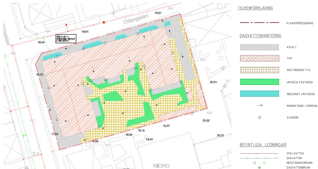
Dagvattenlösningar, förslagskiss. Källa: ÅF Infrastructure AB
