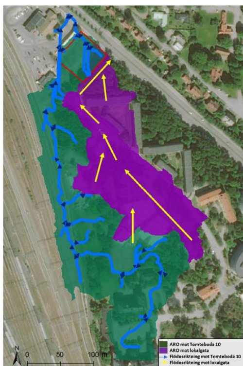
Figur 15. Visar trolig avrinning efter att nytt bostadsområde bebyggs och ny lokalgata anlagts. Det gröna området och blåa pilar representerar avvattningen mot Tomtebod 10. Det lila området och gula pilar visar det område som har fått en ändrad flödesriktning och avvattnas via lokalgatan ut på Solnavägen.
