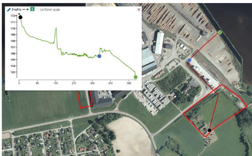
Figur 6.11. Befintlig markprofil längs sträckningen för föreslagen systemlösning för hantering av dagvatten. Högsta punkten markeras med svart cirkel och utlopp till skärbassäng enligt förslaget markeras med grön cirkel. Källa: dagvattenutredning (WSP, 2024).
