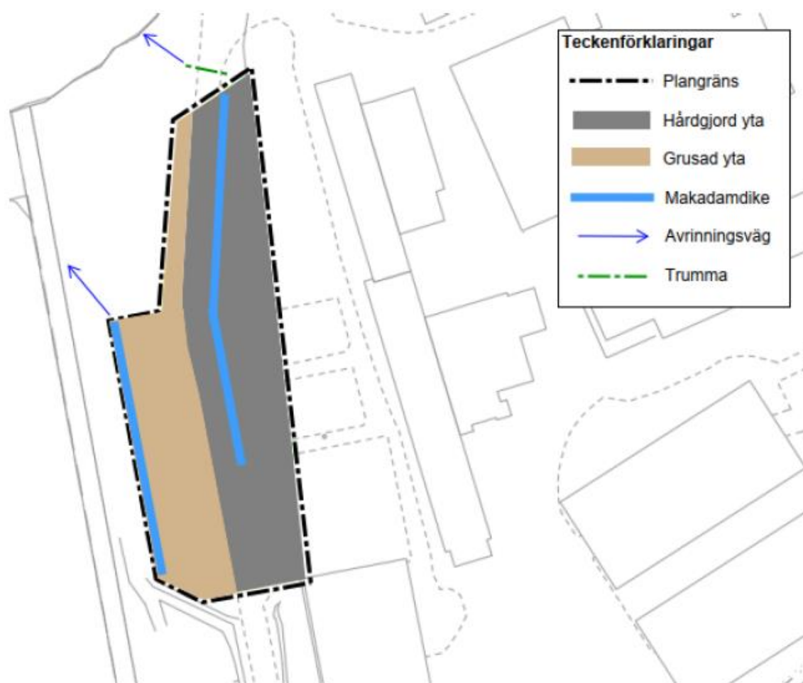
Figur 6.12 Preliminär systemlösning för rening av dagvatten från planområde 2. Källa: Dagvattenutredning (WSP, 2024)
