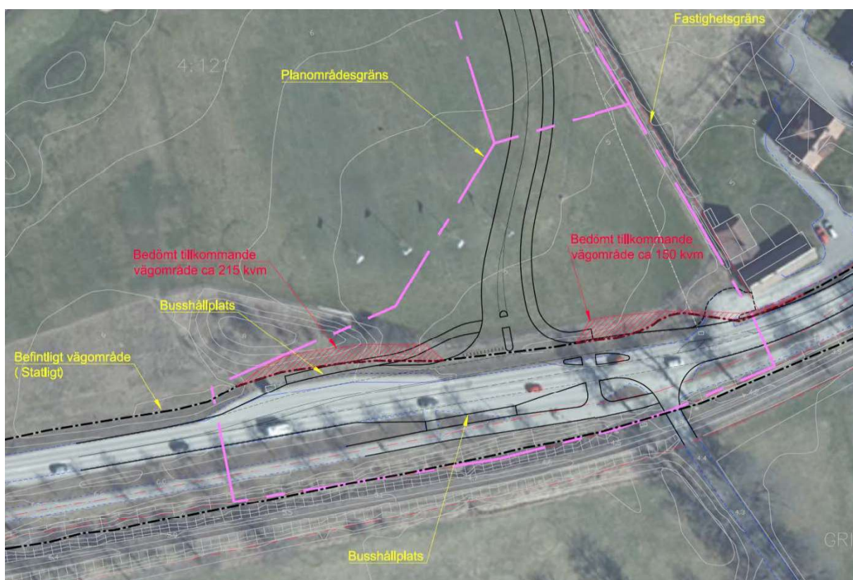
Figur 23. Utformningsförslag på trafiklösning för anslutning till väg 223, VAP VA-Projekt AB.
