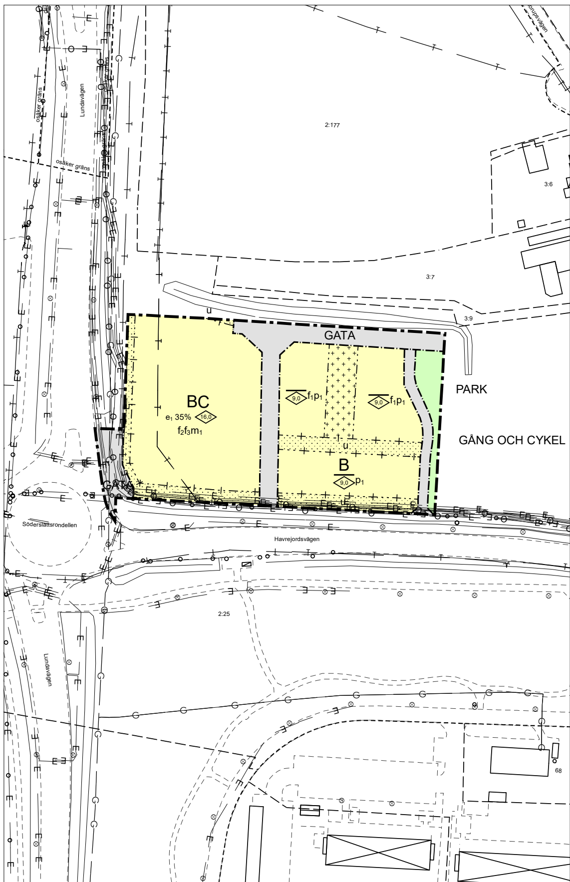
Plankarta som även visar befintliga ledningar.
