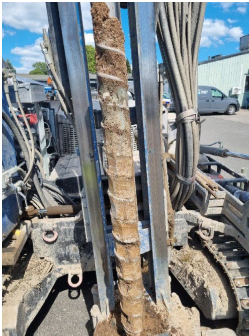
Foto t.h. Borrskruv med lera och sandig morän.
