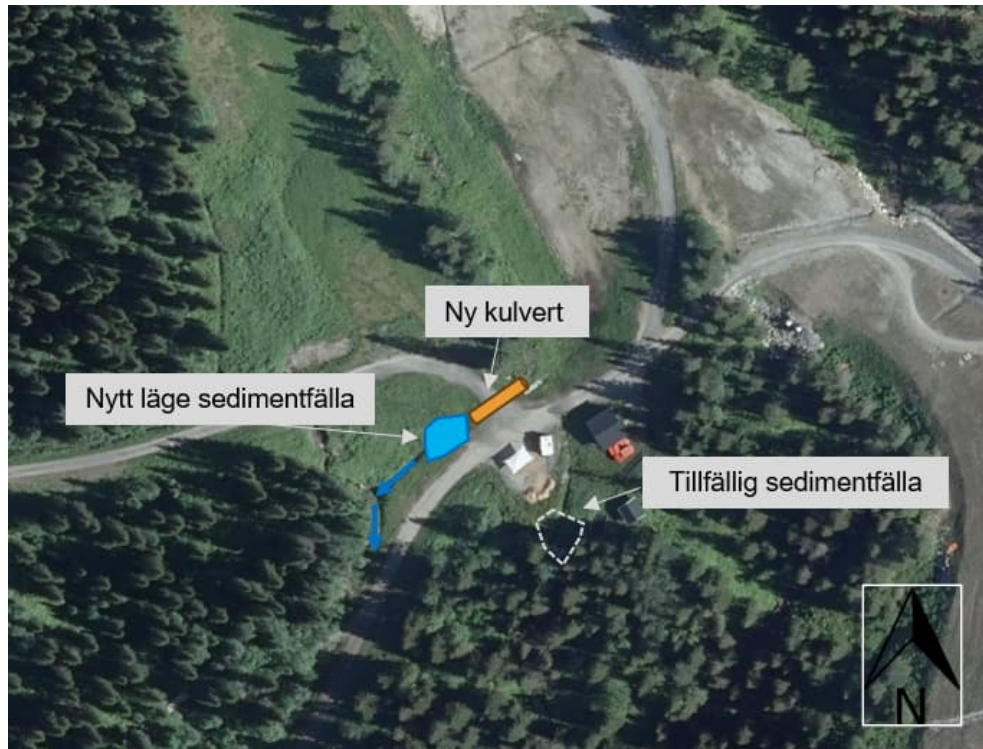
Figur 26. Lokalisering av tillfällig sedimentfälla invid Vikliftens dalstation. Efter byggnation flyttas den drygt 30 meter åt nordväst och kompletteras med ytterligare ytor runt lifthuset (figur 27). (Lantmäteriet, 2023).
