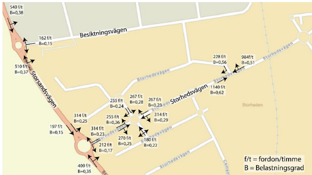
Bild 16: Kapacitetsberäkningar för cirkulationsplatser inom kommunal gatumark samt utfarter från fastighet Storheden 1:37 (Tyréns, 2022).
