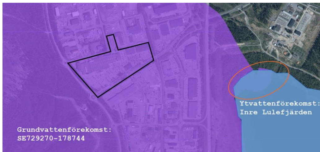
Bild 15: Dagvatten som avleds via kommunens nät släpps ut till ytvattenförekomsten Inre Lulefjärden. Dagvatten som tillåts infiltreras inom Storheden gör det inom grundvattenförekomsten SE729270-178744.
