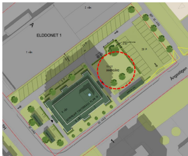
Placering av lågpunkt/ fördröjningsmagasin för hantering och framtidssäkring av skyfallsmängder
