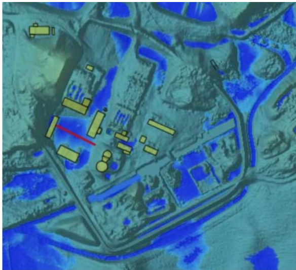
Figur 19. Utdrag ur skyfallsanalys från Scalgo, inklusive ny skyddsvall och ny dikesdragning söder om verksamhetsområdet. Vallen är placerad norr om och parallellt med diket, och sträcker sig runt befintlig anläggning. Rödmarkering visar mätning av vattendjup på gårdsplanen
