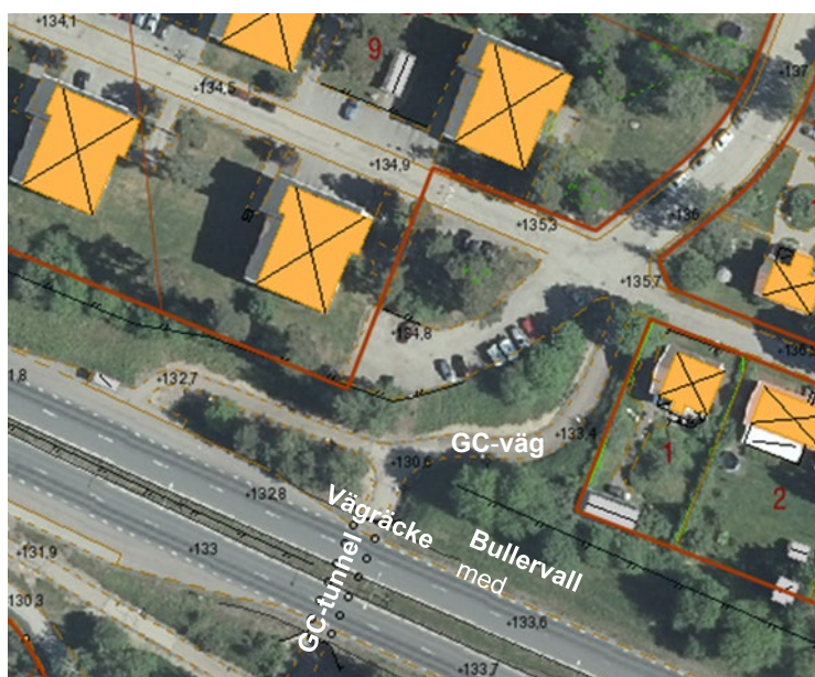
Ovan: Bullervall med staket, vägräcke och nivåskillnader minskar risken för att eventuella avkörande fordon når planområdet
