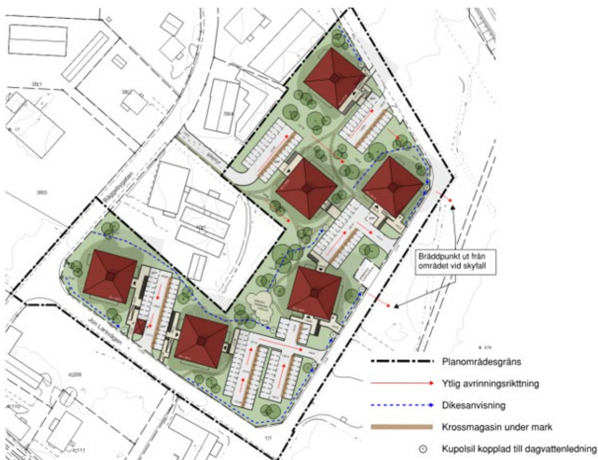
Figur 11: Avvattningsplan (blåstreckad linje = dikesanvisning, röda pilar = ytlig avrinningsriktning, brunmarkerade ytor parkering = krossmagasin under mark).
