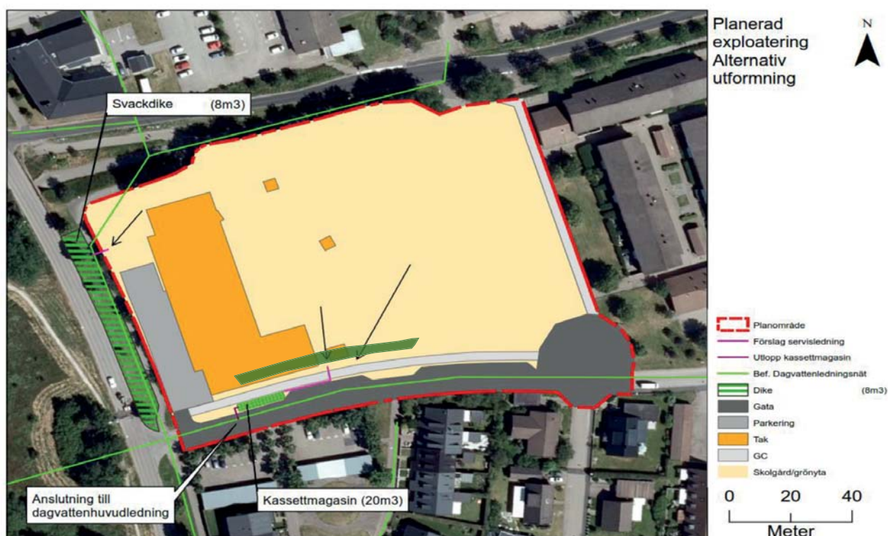
Figur 17. Alternativt principiellt system med dagvattenhantering i dike längs med Fyllingevägen och kassettmagasin längs Jaktfalksvägen.
